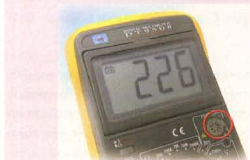
Figura 8.8d. Midiendo la ganancia de corriente
